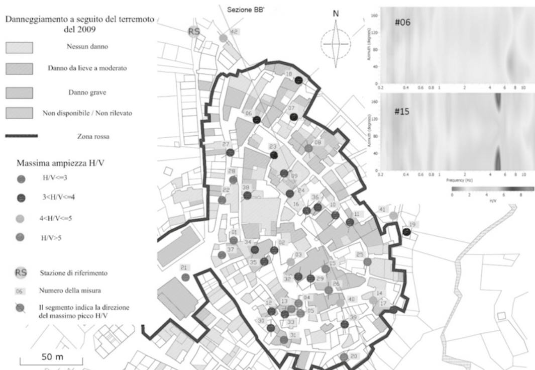
Figura 2. Planimetria con il danneggiamento causato dal sisma del 2009 e ubicazione delle misure di microtremore; in alto a destra sono riportati i diagrammi polari di due misure rappresentative
