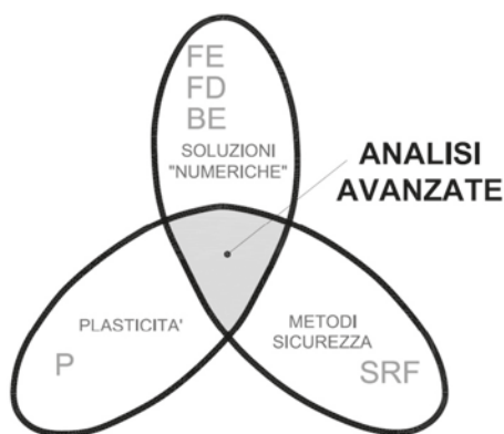
Figura 1 – Tipiche componenti del calcolo geotecnico avanzato (Rabuffetti – 2013)
